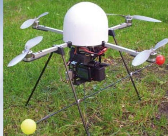
**Quadrocopter mit Videokamera. Der rote und der gelbe Ball dienen zur Lageerkennung bei größeren Distanzen**
