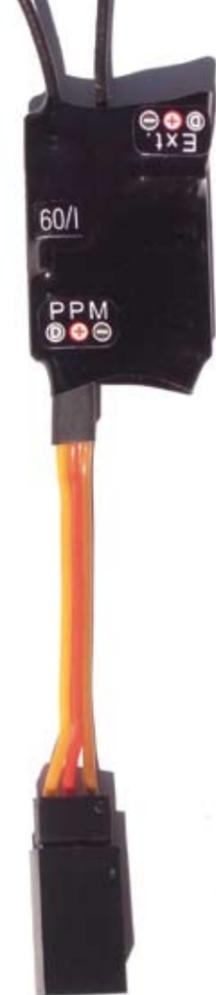
**Rückseite des Jeti-Empfängers. Das Kabel mit dem Stecker ist das PPM-Summensignal. Die beiden dünnen Kabel sind die Antenne. Unten rechts ist der Eingang für die Datenleitung und eine optionale Stromversorgung für angeschlossene Sensoren**
