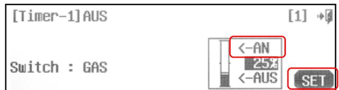
Wir haben nun festgelegt, dass der Timer 2 durch den Gasknüppel aktiviert wird, wenn Gas gegeben wird. Wenn der Gasknüppel auf Leerlauf steht, läuft der Timer nicht weiter.
