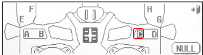
s. Bewegen Sie den Schalter C komplett zu Ihnen hin. Jetzt sollte die Schalterposition [2] angezeigt werden. Drücken Sie in dieser Position auf das **schwarz hinterlegte AUS** Symbol.
