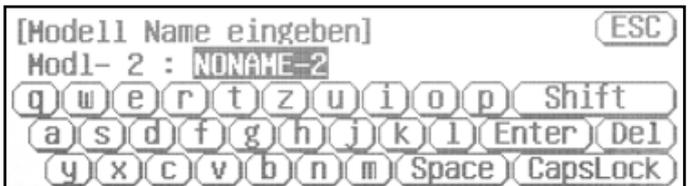
8. Drücken Sie bei der Übertragungsabfrage auf „**N**“ für **Nein**. Es muss noch kein Signal gesendet werden.
