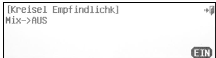
Ohne einen Schalter für die Kreisel-Funktion zu belegen, haben Sie die Möglichkeit in jeder Flugphase einen separaten Wert für die Kreiselempfindlichkeit anzugeben. Wenn Sie einen Schalter mit der Kreisel-Funktion belegen, können Sie verschiedene Empfindlichkeitswerte in den einzelnen Flugphasen abrufen. Sie brauchen zu diesem Zeitpunkt keinen Schalter für die Gyrofunktion belegen. Sie können dies nach Bedarf später nachholen.
