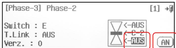
**Wir haben jetzt die Flugphasen Normal, Idle Up1 und Idle Up 2 auf den Schalter E programmiert. Fahren Sie mit der Anleitung fort, um die Gas Hold Funktion auf den Schalter F zu programmieren.**
