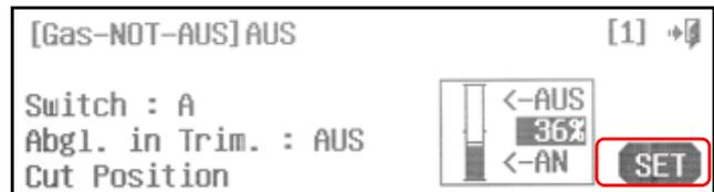
Die Gas – NOT - AUS Funktion wird jetzt nur funktionieren, wenn sich der Gasknüppel im unteren Drittel befindet, und der Schalter H betätigt wird.
