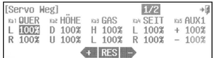
Mit dieser Funktion können sie den Servoweg begrenzen, indem Sie den maximalen Drehwinkel des Servos in beide Richtungen verändern können. Diese Funktion kann Schäden am Servo und am Modell verhindern, durch Vermeidung des mechanischen Anlaufens der Servos.
