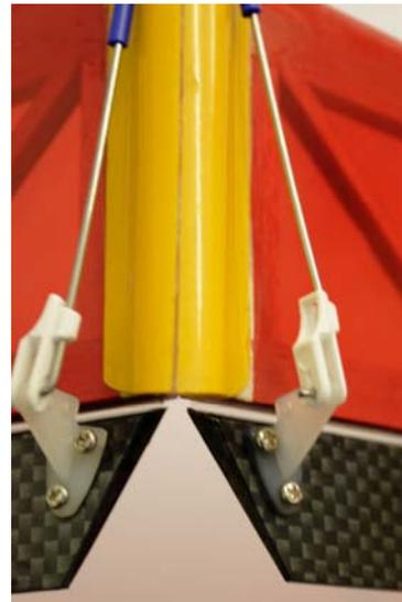
Mit Hilfe der Fernsteueranlage die beiden Servos für das Höhen- und Seitenruder auf Mittenstellung bringen. Die Ruderhälften des V-Leitwerks ebenfalls von Hand so ausrichten, dass Sie exakt in Neutralstellung sind. Anschließend die Klemmschrauben für die Gestänge mit Gefühl fest anziehen. Die Funktionsweise der Servos und Ruder mit der Fernsteueranlage überprüfen und die V-Leitwerks-Mischfunktion gemäß Anleitung der Fernsteueranlage einstellen.
