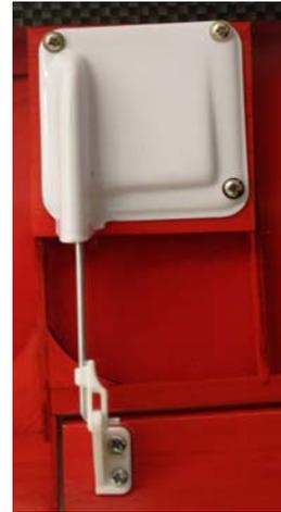
Das Verlängerungskabel wird am Flügelende nach unten herausgeführt. Hierzu muss noch mit einem scharfen Cutter die Bespannfolie vorsichtig entfernt werden.
