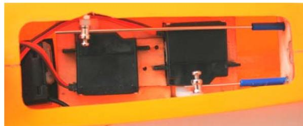
Der Empfänger wird direkt vor dem Servobrett im Rumpf montiert und mit Klettband in Position gehalten. Hier wird ein langer Streifen Klettband auf den Rumpfboden geklebt.
