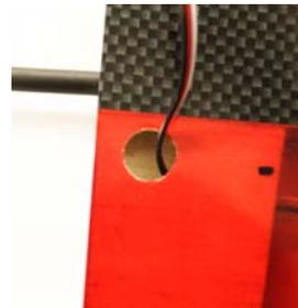
Damit sind die reinen Montagearbeiten abgeschlossen. Der Tragflügel kann nun mit Hilfe des Flächenverbinders zusammengesteckt und mit den Kunststoffschrauben auf dem Rumpf montiert werden. Achten Sie darauf, dass die Servokabel nicht eingeklemmt werden! Gemäß Anleitung der Fernsteueranlage die Querruderkabel in den Empfänger einstecken.
