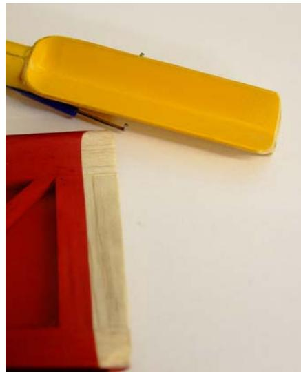
Die beiden Ruderhörner so ausrichten, dass sie sich in einer Linie mit den Anlenkungsgestängen befinden. Mit einer Nadel die Befestigungslöcher durchstechen und die Ruderhörner mit den Gegenplatten festschrauben. Die umgebogenen Gestänge werden im obersten Loch des Ruderhorns eingehängt und mit dem Sicherungsclip gesichert.
