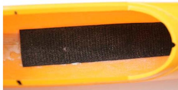
Der Antriebsakku wird zwischen Motor und Empfänger platziert und ebenfalls mit Klettband gesichert.
