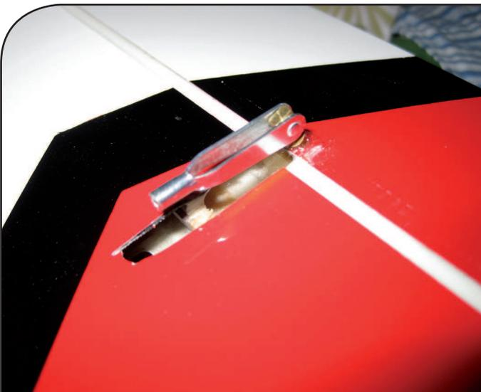
**D**ie Augenschrauben können ohne die beiliegenden Gewindeeinsätze eingeklebt werden. Verwenden Sie hierfür UHUplus endfest 300. Alternativ zum gezeigten Vorgehen ist auch möglich die Anlenkung komplett intern ohne Durchbrüche zu realisieren. Dafür werden die Augenschrauben bündig mit der Dichtlippe eingesetzt.
