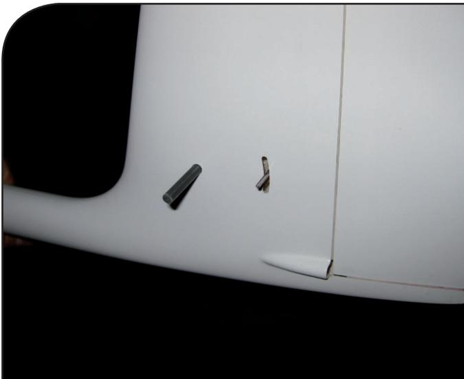
**D**ank dem hinteren Höhenruderstift aus Stahl benötigt das Höhenruder normalerweise keine besondere Sicherung, denn es kann durch leichtes Biegen des Stiftes eine entsprechende Klemmwirkung erzielt werden. Wir empfehlen beide Stifte in eine Höhenruderhälfte einzukleben.
