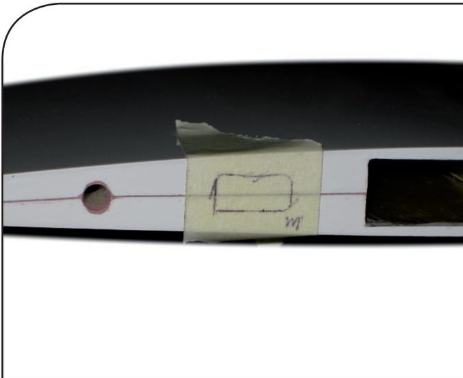
**B**egonnen wird mit dem Anzeichnen und Sägen der Öffnungen für die Servoanschlusstecker an der Tragflächenwurzel. Zeichnen Sie dazu die Kontur eines entsprechenden Steckers (MPX) auf Klebeband auf und befestigen Sie dieses mittig im Bereich zwischen Flächenverbinder und hinterem Arretierstift. Bohren Sie dann die Ecken aus und schneiden mit einem Trennschleifer die Kontur nach.
