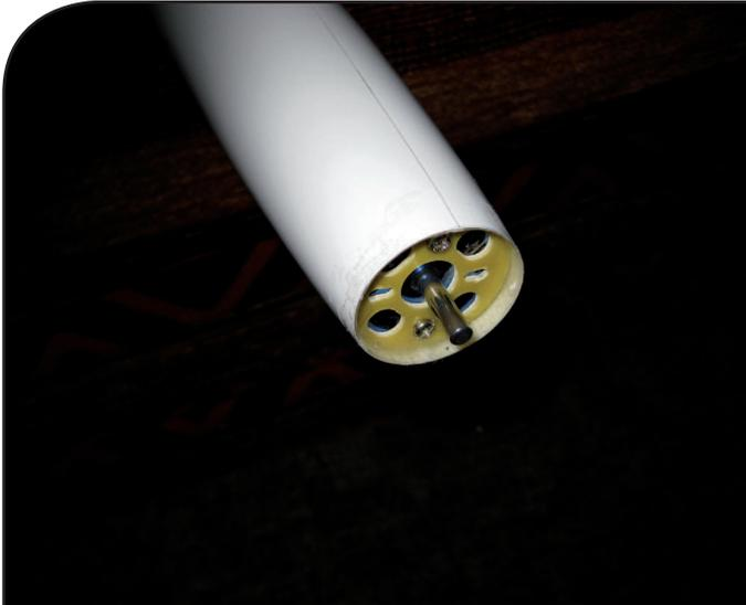
**D**er Motor ist hier eingeschraubt zu sehen. Er wird in kurzem Abstand an den Regler gelötet, wobei zwei Adern steckbar gemacht werden sollten, um ggf. die Drehrichtung einfach wechseln zu können.
