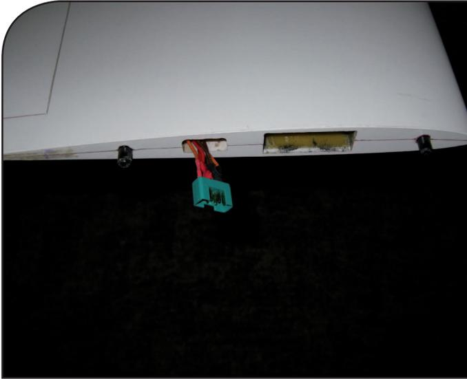
**D**ie Arretierungszapfen aus Kohlefaser werden mit 5 min Epoxy oder besser UHUplus endfest 300 eingeklebt. 8 mm sollen herausstehen.
