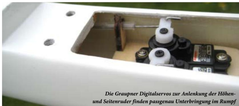
Die Graupner Digitalservos zur Anlenkung der Höhen- und Seitenrudder finden passgenau Unterbringung im Rumpf
