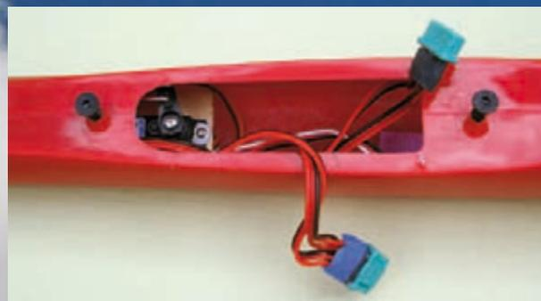
► Im Testmodell wurde der von Staufenbiel empfohlene Antrieb eingesetzt: Dymond IL 2854-1300 Innenläufer und Dymond Smart 30 Regler.
