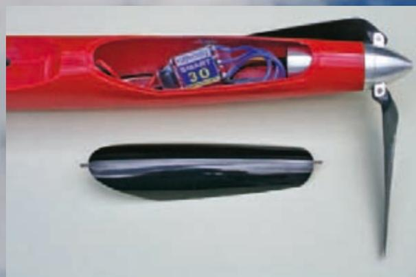
► Muss noch abgesägt werden: die Rumpfnase. Bis zu einem Durchmesser von 34 mm ist sie fast kreisrund und ermöglicht daher auch Motoren und Spinner eigener Wahl.
