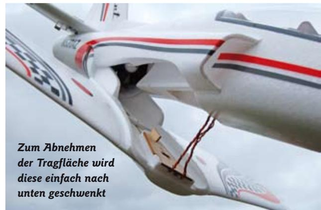
**Zum Abnehmen der Tragfläche wird diese einfach nach unten geschwenkt**
