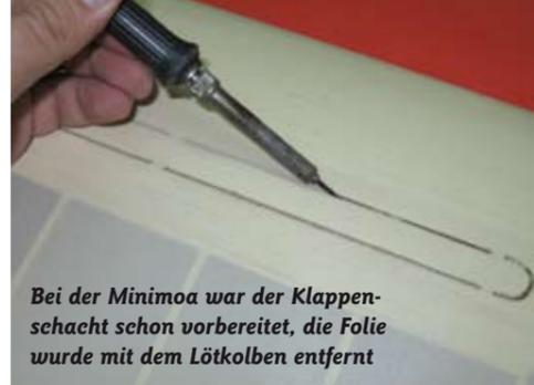
Bei der Minimoa war der Klappenschacht schon vorbereitet, die Folie wurde mit dem LötKolben entfernt
