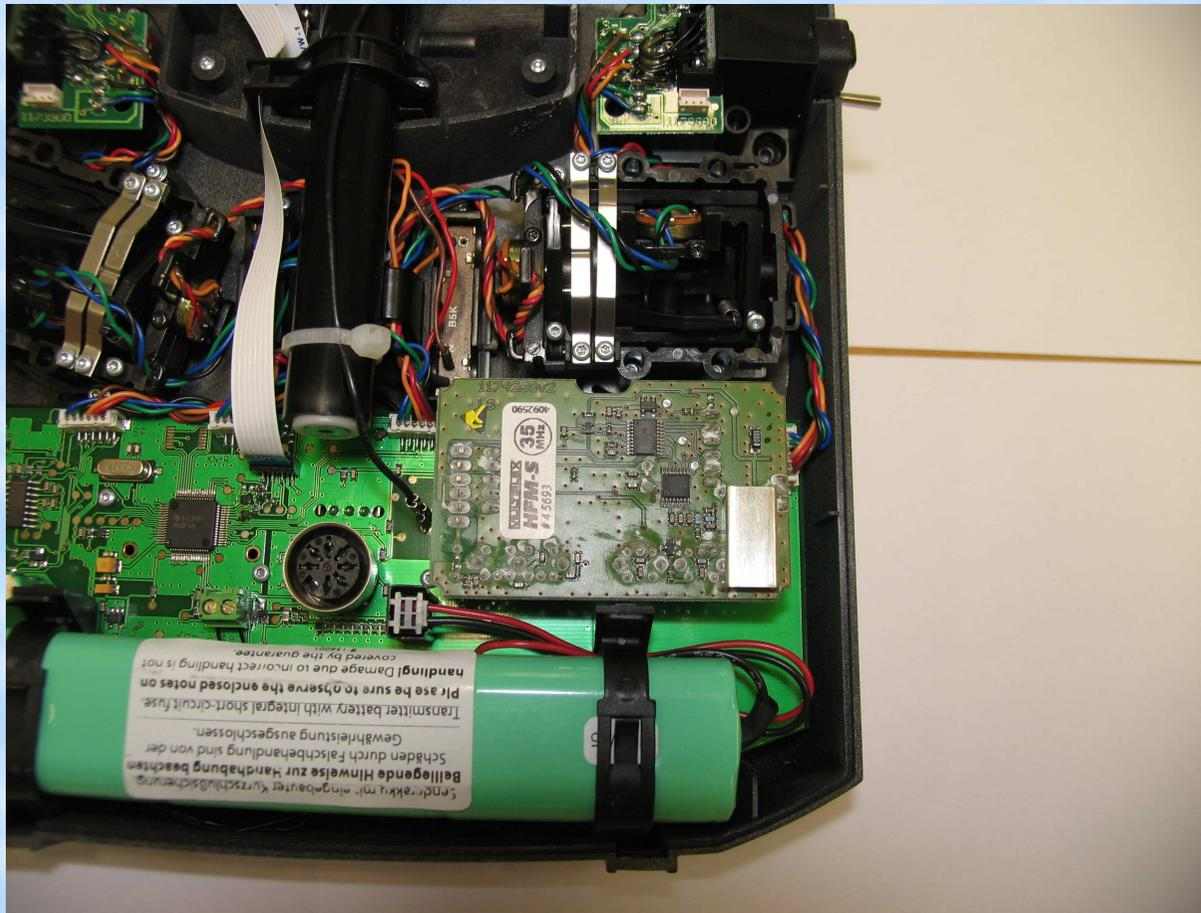
Auf die hintere Seite des TU Moduls kleben Sie beidseitig klebendes Schaumgummiband oder Klettband.
