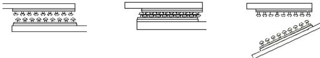
Dual Lock™ SJ 4570, dünner, flexibler Druckverschluss ist zudem selbstklebend ausgerüstet, für permanente Verbindungen. Hierdurch werden bekannte Nachteile herkömmlicher Befestigungssysteme vermieden: Kein umständliches Arbeiten mit Schrauben und Nieten, keine sichtbaren Löcher, die das optische Aussehen einer Oberfläche beeinträchtigen.
