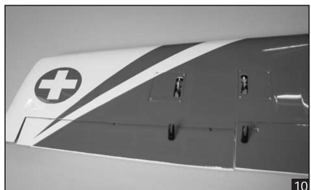
**INSTALLING THE AILERON LINKAGES**
