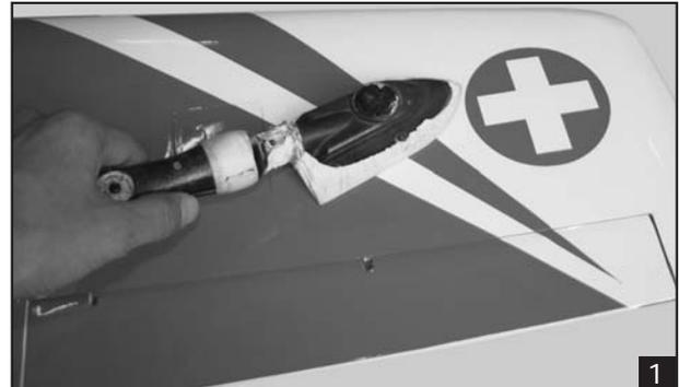
**INSTALLING THE AILERON AND FLAP SERVOS**
