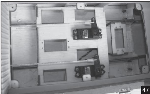
**INSTALLING THE RUDDER SERVO**
