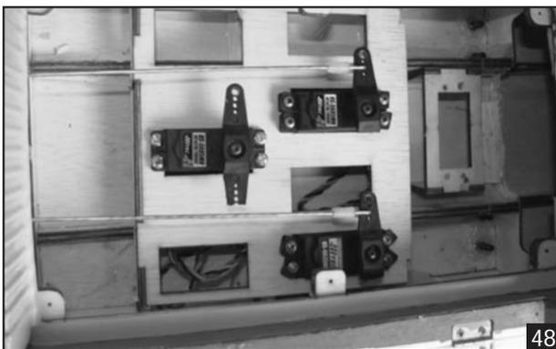
**INSTALLING THE RUDDER LINKAGES**
