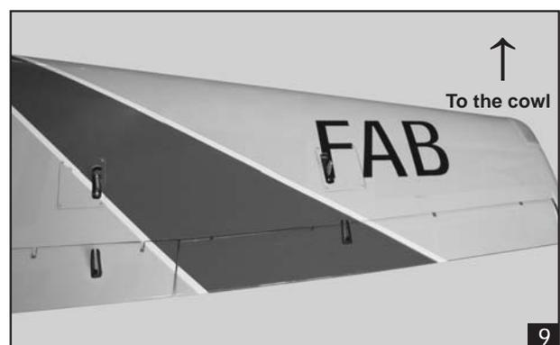
**INSTALLING THE AILERON LINKAGES**
