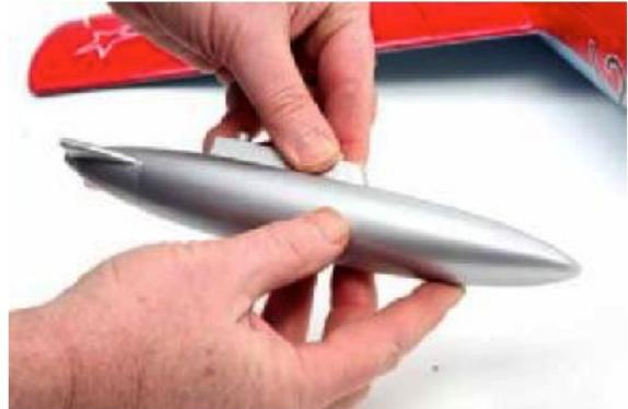
15. Kleben Sie die Abwurf tanks an der Unterseite der Tragfläche fest.
