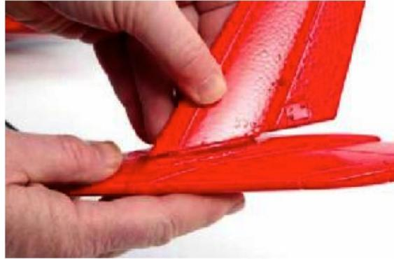
3. Stellen Sie sicher, dass das Höhenruder einen Winkel von 90° zur Seitenflosse einnimmt. Bohren Sie nach dem Aushärten des Klebers ein Loch  $\varnothing$  3,0 mm durch die Seitenflosse in das rechte Höhenruder.
