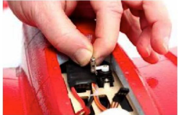
13. Bringen Sie beide Höhenruder und den Servoarm des Höhenruderservos in die neutrale Position. Stellen Sie sicher, dass die Höhenruder in neutraler Position bleiben und ziehen Sie die Schraube am Servoarm fest, die die beiden Schubstangen hält.
