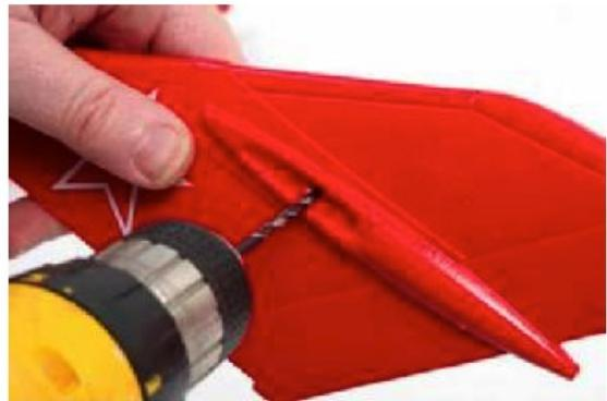
4. Kleben Sie das zur Verstärkung dienende 3 mm Rohr mit wenig Epoxy ein. Bohren Sie an passender Stelle ein Loch  $\varnothing$  3,0 mm in das linke Höhenruder, schieben Sie es zur Kontrolle auf das eingeklebte Rohr auf und kleben Sie das linke Höhenruder, falls alles korrekt sitzt, mit Epoxy-Kleber fest.
