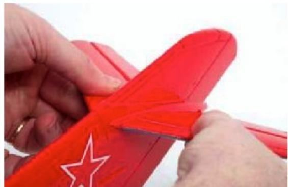
5. Stellen Sie bitte sicher, dass auch das linke Höhenruder einen Winkel von 90° zur Seitenflosse einnimmt. Tragen Sie Epoxy-Kleber auf die Wurzel einer Tragfläche auf.
