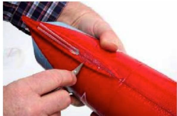
10. Kleben Sie die Seitenflosse fest. Stellen Sie dabei sicher, dass das linke Führungsröhrchen für das Höhenrudergestänge durch die Seitenflosse geführt wird.
