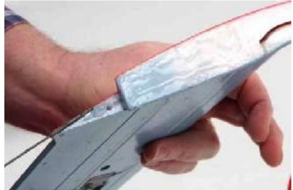
6. Führen Sie das Kabel des Querruder-Servos durch das Loch im Rumpf und schieben Sie die Tragfläche bis ganz an den Rumpf.
