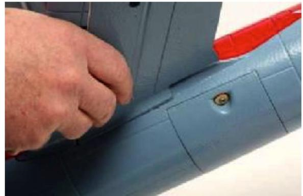
7. Überprüfen Sie bitte sowohl die Ober- als auch die Unterseite der Tragfläche, um sicher zu gehen, dass diese wirklich ganz am Rumpf anliegt.
