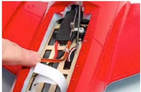
17. Installieren Sie den Empfänger. Die Servos für die Querruder können entweder über ein Y-Kabel verbunden oder einzelnen Kanälen zugeordnet werden, je nachdem, wie Ihre Fernbedienung dies ermöglicht.
