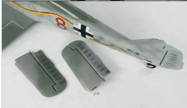
Setzen Sie die linke und rechte Höhenflosse auf die Bolzen am Seitenleitwerk.
