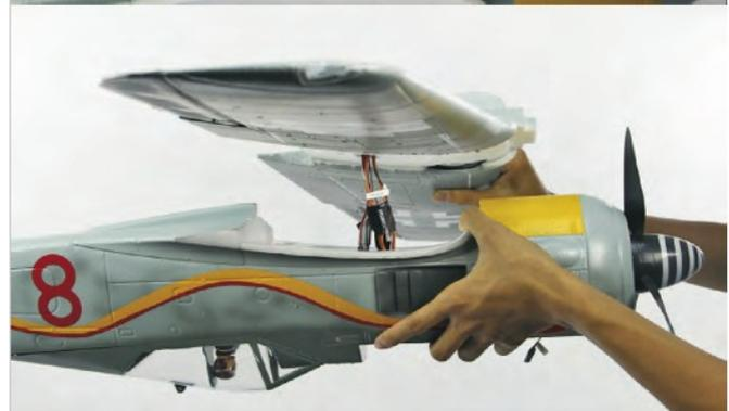
Verlegen Sie die Kabel der Querruderservos in das Abteil für die elektrischen und elektronischen Komponenten.
