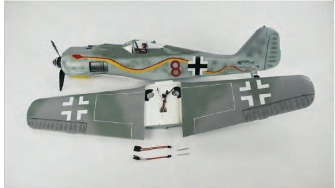
Verbinden Sie die Kabel der Querruderservos und der Einziehfahrwerke jeweils mit einem Y-Kabel.
