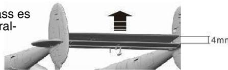
3. Wir empfehlen Ihnen, die Landeklappen mit „Tiefenruder“ zu mischen: 1,5 mm Höhenruder nach unten für die „niedrige“ und 3 mm Höhenruder nach unten für die „hohe“ Landeklappen-Rate.
