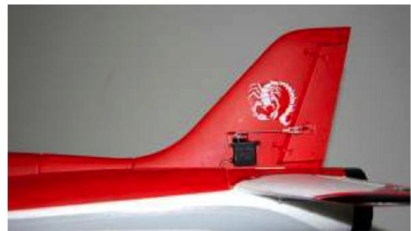
4. Stellen Sie sicher, dass die Ruder parallel zur Tragfläche/Höhen-/Seitenflosse stehen. Verbinden Sie die Ruderhörner mit den Gabelköpfen und sichern Sie die Gabelköpfe mit dem Silikonring.
