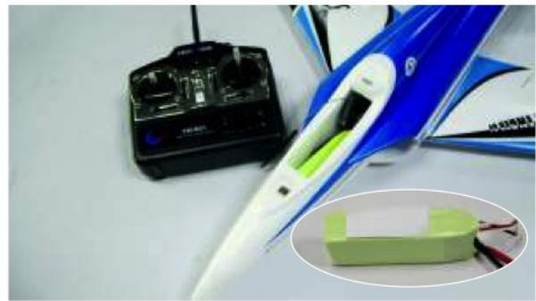
3. Schalten Sie den Sender ein und verbinden Sie den Akku mit dem Empfänger. Stellen Sie sicher, dass alle Servoarme in der mittleren Position stehen.
