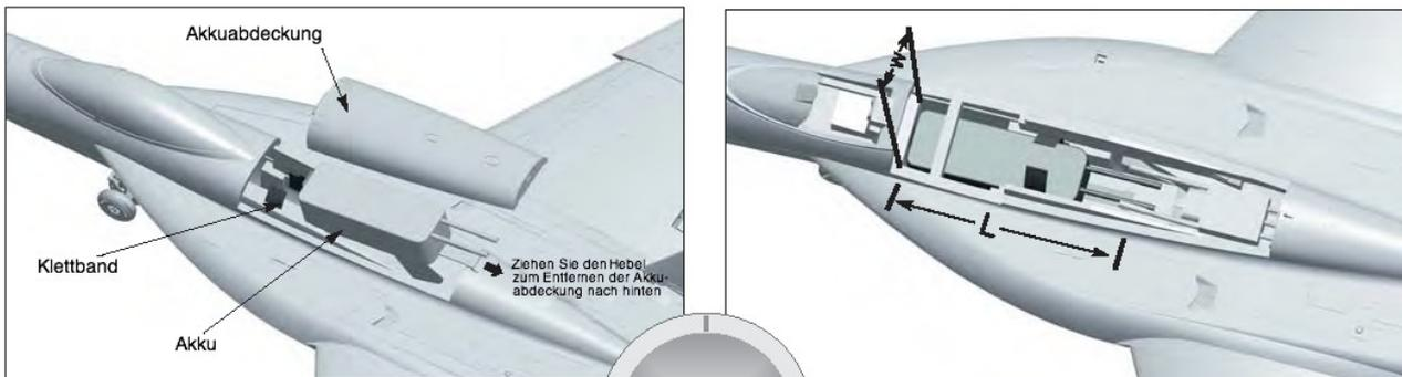
Ziehen Sie die Arretierung der Akkuabdeckung nach hinten, entfernen Sie diese und fixieren Sie den Akku mit dem Klettband. Bitte stellen Sie vor dem Verbinden des Akkus mit dem Empfänger sicher, dass Ihr Sender eingeschaltet und das zum Flugzeug passende Programm gewählt ist.
