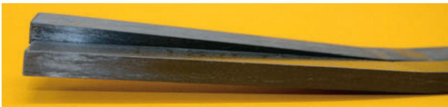
Hier wird sie deutlich, die unterschiedliche V-Form der Flächenverbinder
