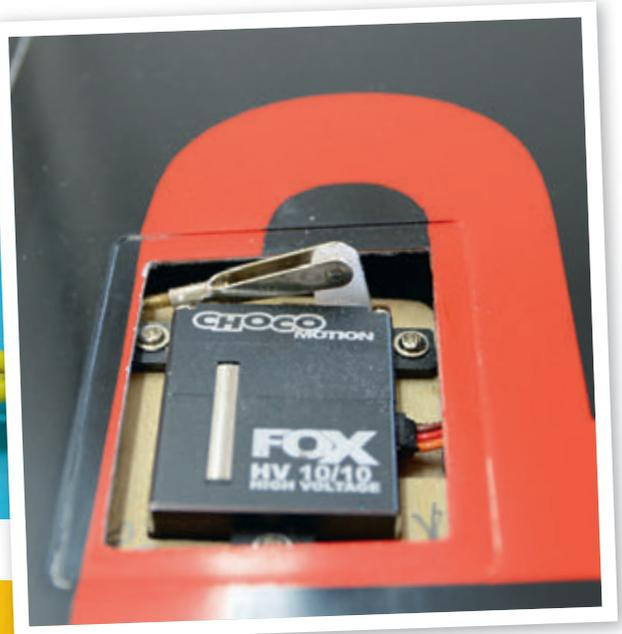
Servoeinbau im Fall einer Über-Kreuz-Anlenkung
