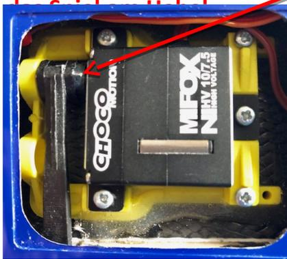
Bohrung 1,0 mm
