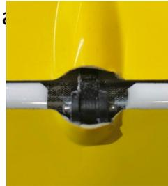
Ruderhorn unten etwas abrunden, damit das Ruderhorn nicht das Scharnier blockiert. Das Ruderhorn um 10 mm kürzen und in Wölbklappe einpassen.
