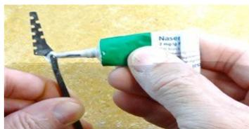
Ruderhornscharnier mit **Fett** oder **Nasensalbe** (lässt sich dank dünner Öffnung gut dosieren) rundum benetzen, damit keine Scharnierverklebung erfolgt.
