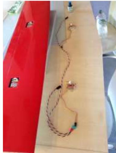
Servodeckel zurechtschneiden und mit Tape zukleben
