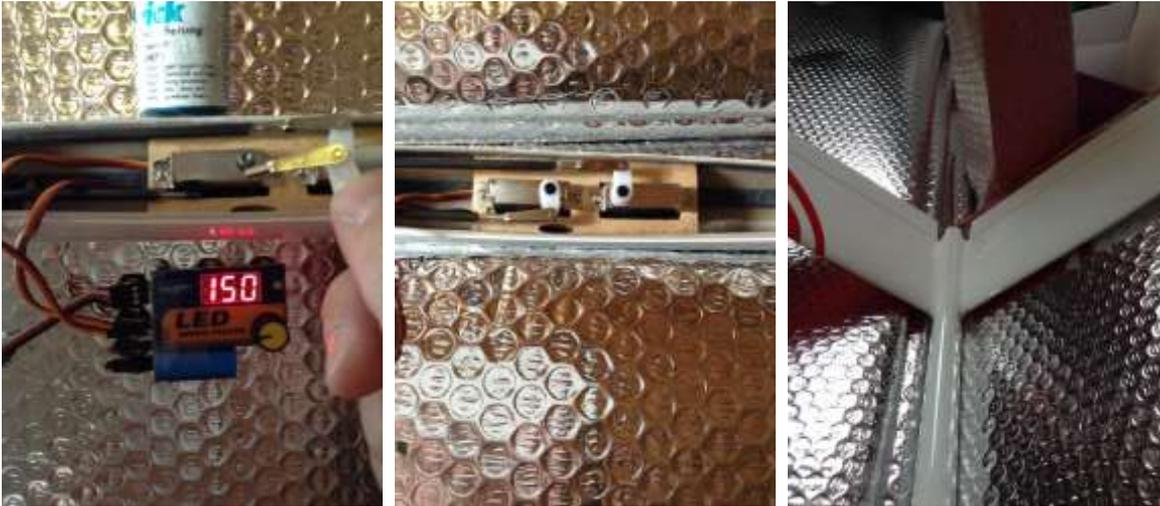
Die Rumpfaufnahme der Multiplexstecker wird vorsichtig erweitert. Der innere Rand ist bisschen eng für die vorkonventionierten Kabel. Zudem hab ich noch nen Keil vorbereitet zum Ballastrohrverschluss nach vorne abstützen.
