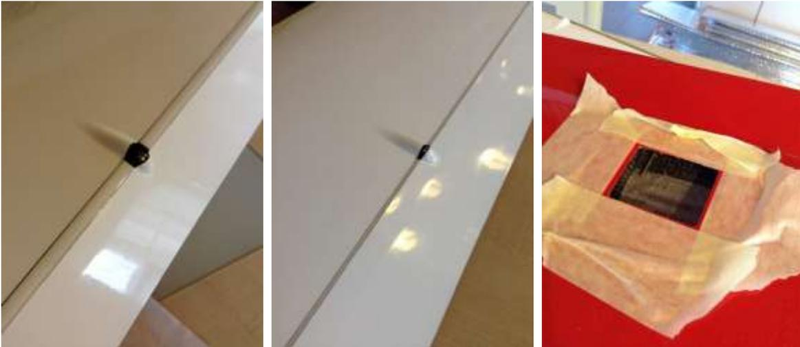
Zum ablängen der Anlenkstangen des Leitwerks montiere ich das selbige. Das Leitwerk wird mit je einer Vollkohlestange auf das Rumpfeende gesteckt. Die Kohlestangen sind z.t. zu lange und werden noch gekürzt.
