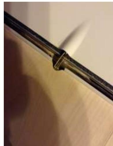
Auch eingeharzt wurde bereits das Servobrett, das Ballastrohr und die Gewindestangen mit Gabelköpfen an den beiden noch nicht abgelängten Leitwerksschubstangen. Vor dem Ballastrohr wird noch ein zusätzlicher Stützkeil auf dem Boden verharzt. Die Wucht des Ballastes sollte bei einer unsanften Landung nicht unterschätzt werden.
