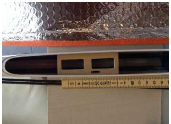
Das Ballastrohr hat einen 40mm Ausschnitt erhalten sowie an der vorderseite einen sperrholzverschluss.
