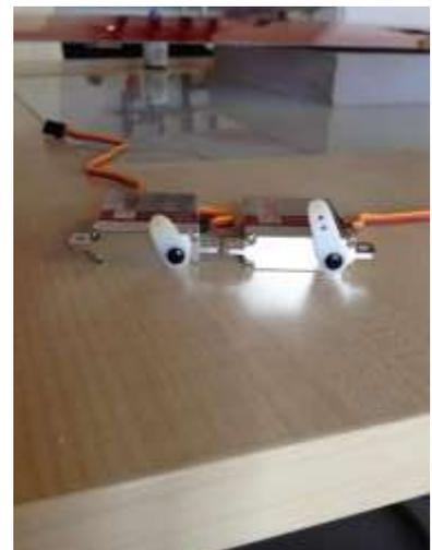
Gabelkopf auf die lose Gewindestange im Flügel schrauben, Servokabel einstöpseln und irgendwie sichern.
