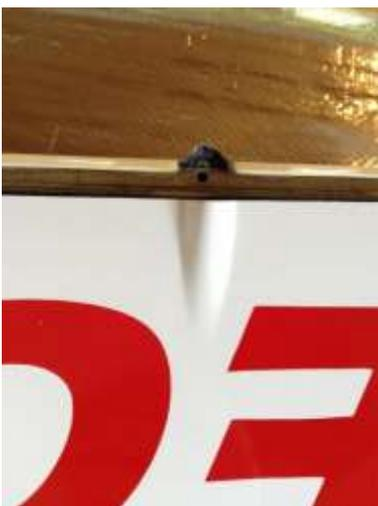
Der Hilfsholm muss angebohrt werden, da kommt das Rudergestänge durch.
