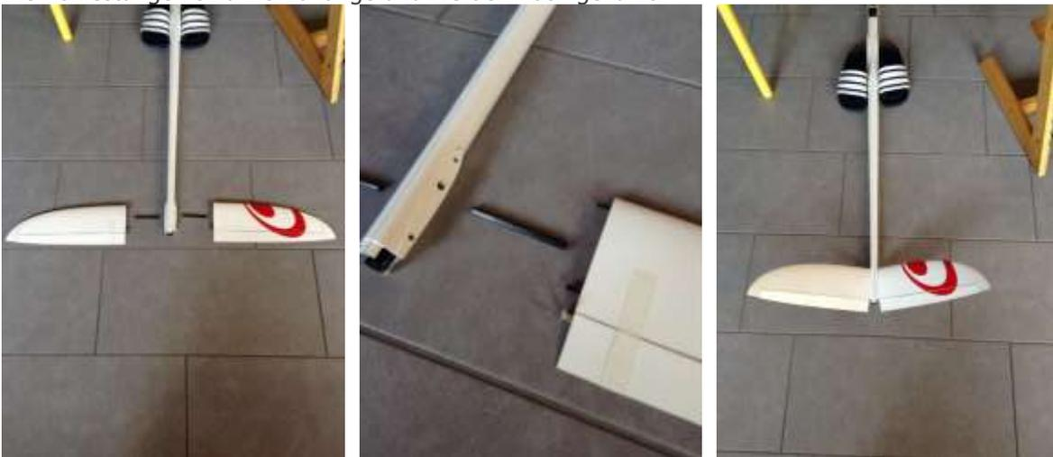
Nun werden die Schubstangen eingeklipst. Wenn die Ruderfläche nach unten gebogen wird geht das unkompliziert und schnell.
