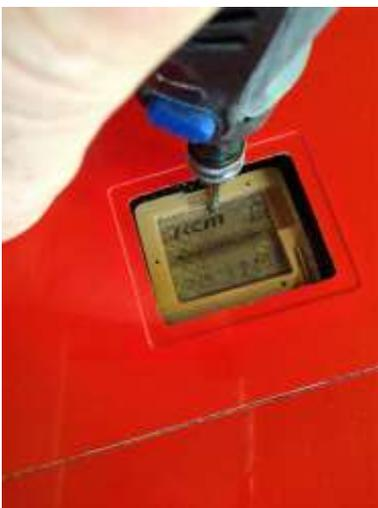
Ebenso wird über den Schraubenlöcher des Servorahmens der Vertiefte Rand des Flügels zurückgeschliffen. Die rechtecklöcher für die Multiplexstecker sind im Durchmesser grnau passend zum verleimen. Ich mach das nur noch Rumpfseitig und ziehe die Stecker lose aus dem Flügel. Sicher ist sicher.
