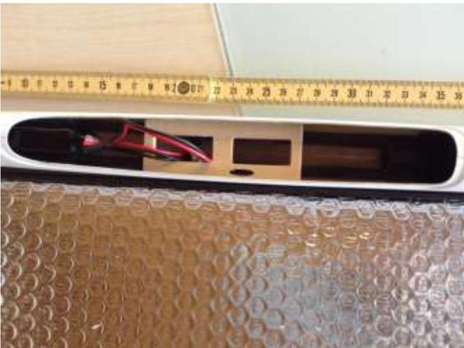
Das Ballastrohr wird ca 20mm in den vorderrumpf ragen, und bis ca 50-60mm hinter dem Flügelende in den Rumpf schauen.
