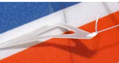
**Die GFK-Ruderhörner sind mit Sekundenkleber befestigt. Der Faden der Seilanklung ist daran verknotet und mit dem Servohorn verbunden. So ergibt sich eine spielfreie und vor allem leichte Anlenkung**
