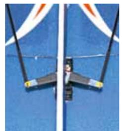
**Die V-Form des Querruderhebels hebt die mechanische Differenzierung durch die asymmetrische Anlenkung auf. Die Z-Stahldrähte erlauben vor dem Verkleben das genaue Einstellen der Anlenkungen**
