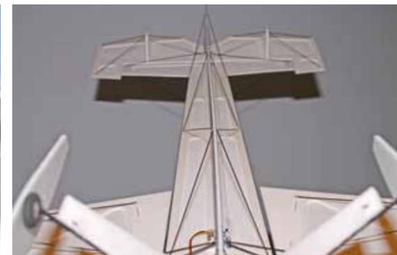
**Aus dieser Perspektive ist die Gerüststruktur der Rumpfabstreben erkennbar. Sie sind mit Beli-Zell verklebt und in der Länge vorgegeben**
