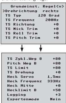
Bei Aktivierung eines Wertes in Grundeinstellung Regel wird die Gyro-Regelung und teilweise die Steuerung deaktiviert! Daher dürfen Änderungen nicht in der Luft durchgeführt werden, sondern müssen am Boden ohne Drehzahl erfolgen!
