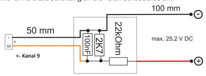
Dieser Spannungsteiler ist in den Reglern S3082 und S3083 enthalten.
