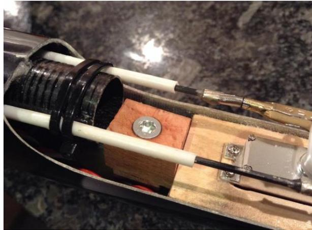
Am Rumpf werden die Öffnungen für die Flächenverkabelung leicht ausgeweitet und die Kabel eingezogen. Die Stecker sparsam mit Harz einkleben.
