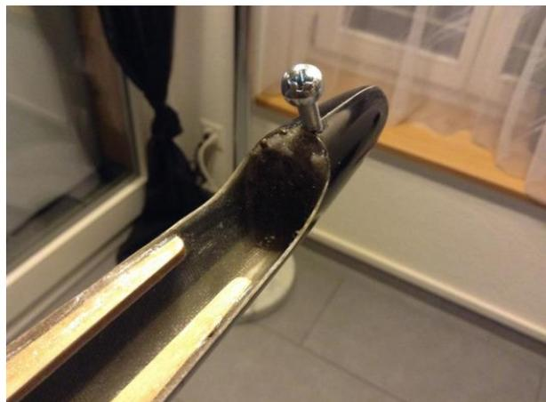
Harzkleber mit Stahlkugeln vermischt in die Nase "schütten". Die Schraube wird z.B. mit Klebeband in der gewünschten Position fixiert. Wenn das Gemisch ausgehärtet ist Klebeband entfernen und Schraube wieder herausdrehen.
