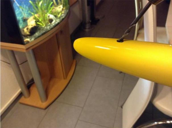
M5 Schraube das Gewinde gut Fetten und 2 Muttern draufschauben. Die Schraube wird durch das Loch im Innerrumpf geschoben und erst dann die Beiden Muttern draufgeschraubt.
