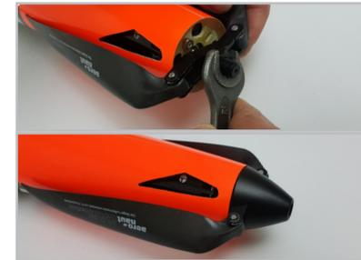
Montieren Sie das Luftschrauben Mittelteil mit den Luftschraubenblättern auf der Motorwelle. Achten Sie auf ein festes, aber gefühvolles Anziehen der Mutter. Es handelt sich hier um ein Aluminium Gewinde!
