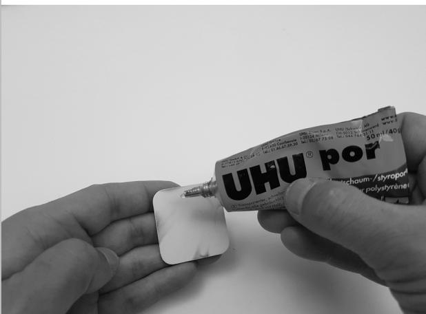
Nun kann der Servoschacht mit dem Deckel verschlossen werden. Kleben Sie die Abdeckung mit UHU Por oder doppelseitigem Klebeband auf den Rahmen des Schachtes.
