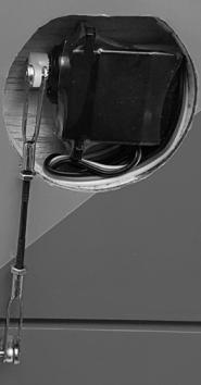
Raccordez les tiges d'aileron aux guignols de la gouverne de direction et du palonnier. S'assurer que la gouverne de direction est placée en position neutre. Si nécessaire, ajustez les tiges.
