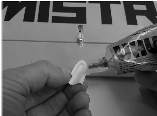
Kleben Sie die Servoschacht- und Gestängeabdeckungen erst nach allen elektronischen Einstellarbeiten mit UHU-Por auf. So können die Gestänge noch feinjustiert werden.
