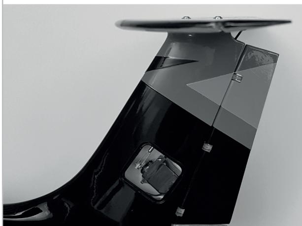
Vérifiez la longueur de la tringlerie de profondeur et corrigez-la si nécessaire. La gouverne de direction doit être en position neutre à la position du palonnier à 90°.
