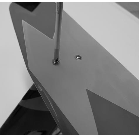
Monter la gouverne de direction sur le fuselage avec les deux vis M3x10 et fixer la tringlerie avec le guignol. S'assurer que les vis sont bien serrées, attention ne pas forcer le serrage.
