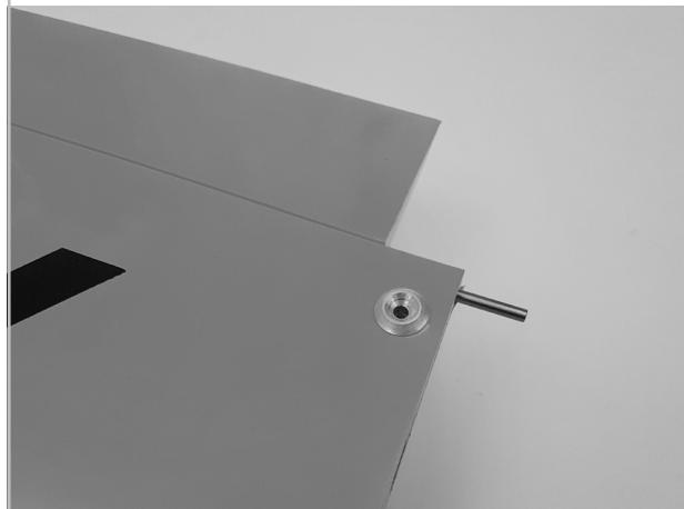
Kleben Sie mit Epoxy die Aluminium Anpressscheiben zur Flächenbefestigung auf die Bohrungen der Flächenschrauben. Entfernen Sie zuvor die Folie darunter. Den 3mm Torsionsstift kleben Sie in die Wurzelrippe der rechten Tragfläche ein (vorher leicht anrauen und entfetten).
