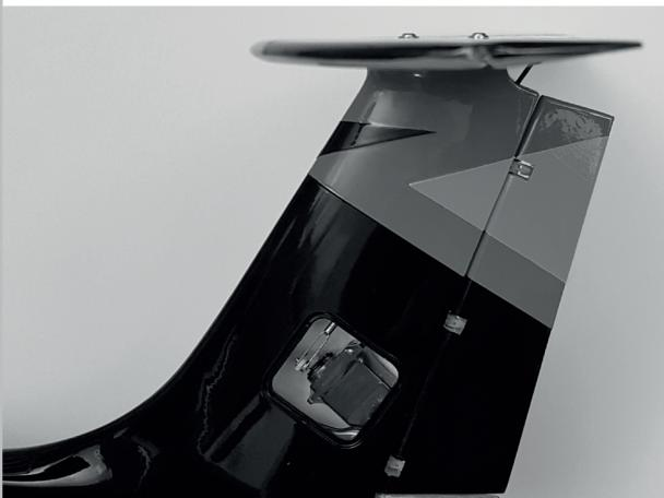
Kontrollieren Sie die Länge des Höhenrudergestänges und korrigieren Sie diese ggf. am Gabelkopf. Das Ruder sollte sich bei 90° Servoarm-Stellung in Neutrallage befinden.
