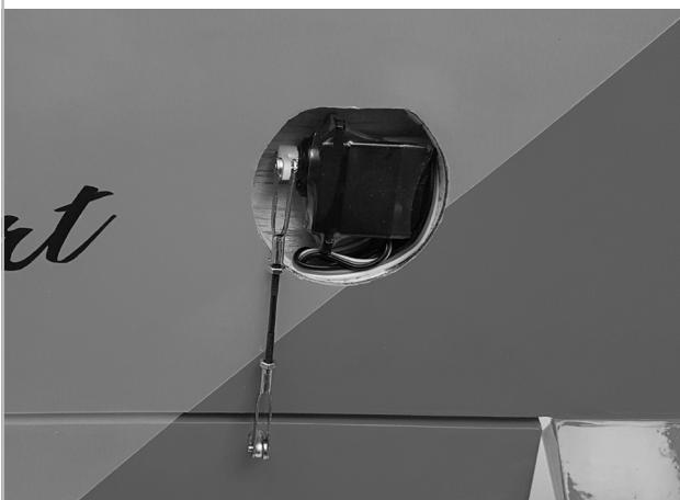
Hängen Sie die 50mm Querrudergestänge in die Ruder- und Servohörner ein (äußeres Servo). Achten Sie wieder auf Ruderneutral-lage bei rechtwinkligem Servohorn und stel- len dies ggf. an den Gabelköpfen nach.
