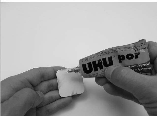
Coller le couvercle de l'emplacement du servo avec de l'UHU Por ou une bande velcro.
