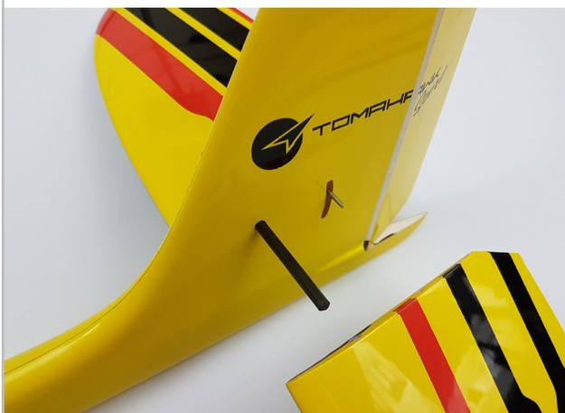
Das Höhenruder wird mit dem Cfk Rohr einfach durch die Rumpfböhrung und mit dem 2mm Stahlstift durch die Böhrung im Umlenkhebel gesteckt.
