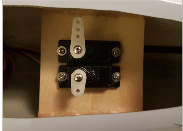
Die Servos werden in das vorgesehene Servobrett geschraubt und bereits jetzt neutral ausgerichtet. Den Servoarm montieren Sie im 90° Winkel.
