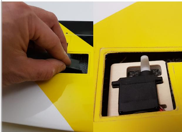
ARF: Bauen Sie zunächst die Servos sinngemäß in den Servoschacht ein. Wir empfehlen die Verwendung von entsprechenden Servohörnern. Die Servokabel ziehen Sie mit einem Draht durch die vorgesehenen Öffnungen. Als Verbindung zum Rumpf sollte das grüne 6-pol MPX Stecksystem verwendet werden.
