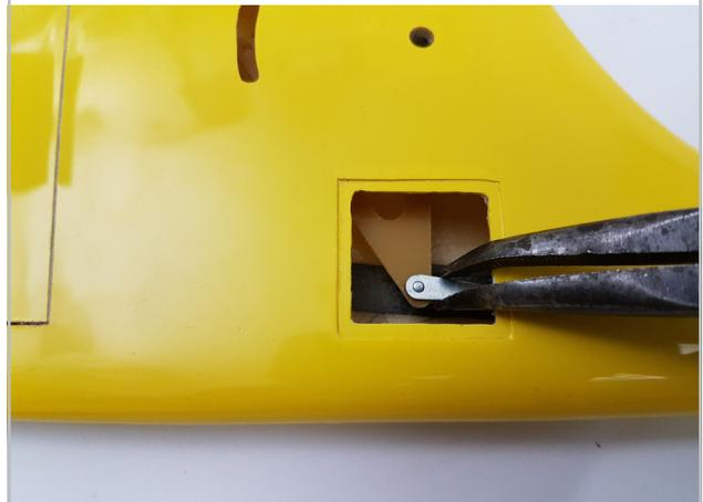
Das Höhenruderrudergestänge wird hinten am Umlenkhebel und vorn am Servohebel bei 90° eingestellt und eingehängt.
