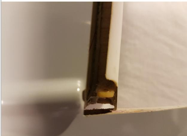
Das Seitenruderhorn sorgfältig anschleifen und mit angedicktem Epoxyharz im Seitenruder einkleben.
