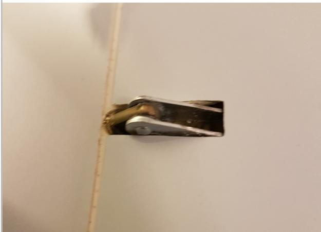
Hängen Sie die Querrudergestänge in die Ruder- und Servohörner ein (äußeres Servo). Achten Sie wieder auf Ruderneutrallage bei rechtwinkligem Servohorn und stellen dies ggf. an den Gabelköpfen nach.
