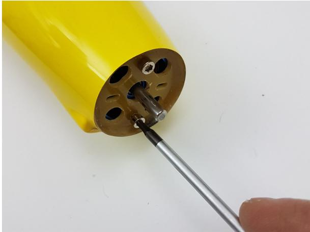
Montieren Sie zunächst den Motor mit zwei Innensechskant Schrauben an dem Spant. Dann montieren Sie den Spinner auf der Motorwelle und die Luftschraubenblätter.
