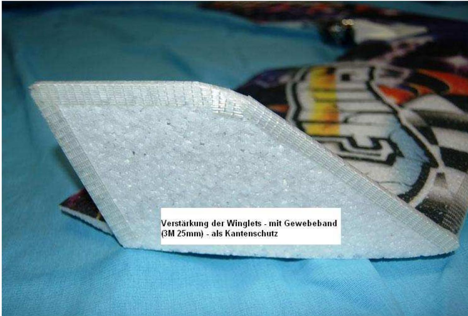
**Verstärkung der Winglets - mit Gewebeband
