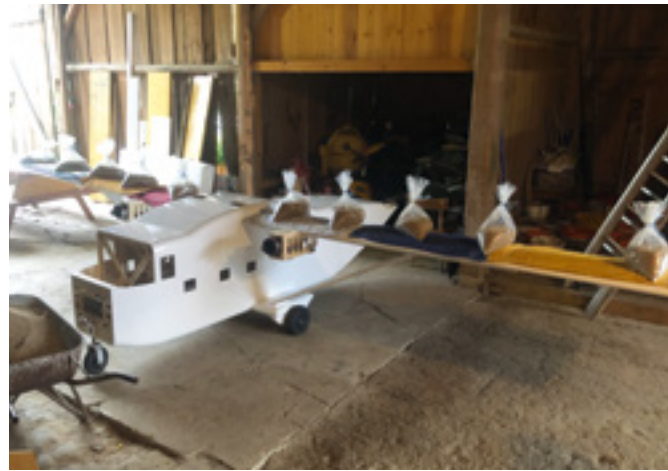
Erste Belastungsproben der Struktur stellen sicher, dass das Modell auch stabil genug konstruiert ist, um den im Flug auftretenden Kräften standzuhalten
