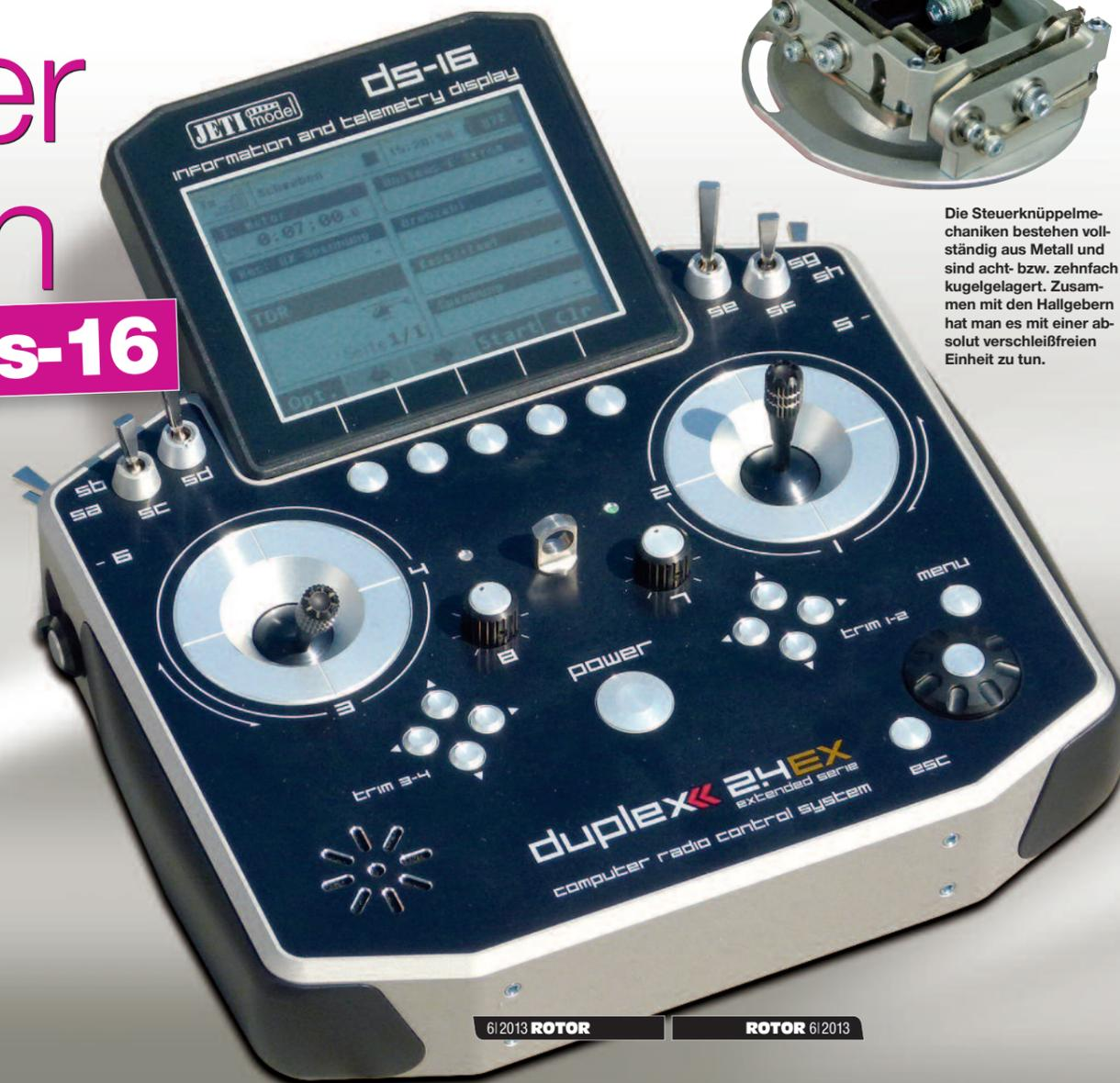
Die Steuerknüppelmechaniken bestehen vollständig aus Metall und sind acht- bzw. zehnfach kugelgelagert. Zusammen mit den Hallgebern hat man es mit einer absolut verschleißfreien Einheit zu tun.
