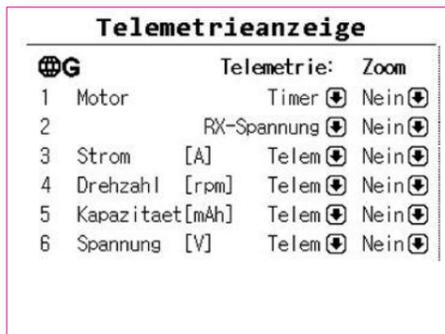
Im Menü »Telemetrieanzeige« werden die Sensoren ausgewählt, deren Werte im Display der ds-16 angezeigt werden sollen.
