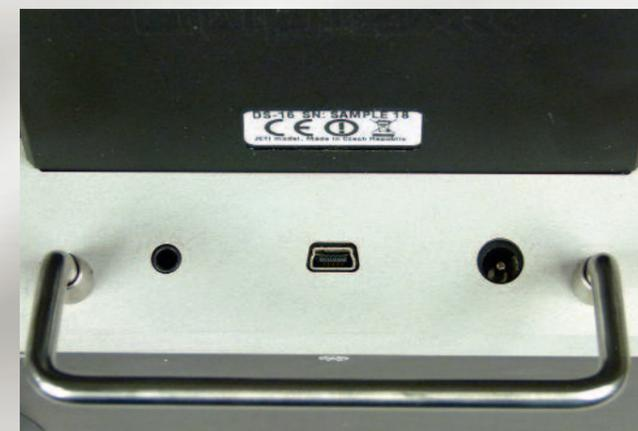
Unterhalb des Displays sind Buchsen für Kopfhörer, USB-Verbindung und das Laden angebracht.
