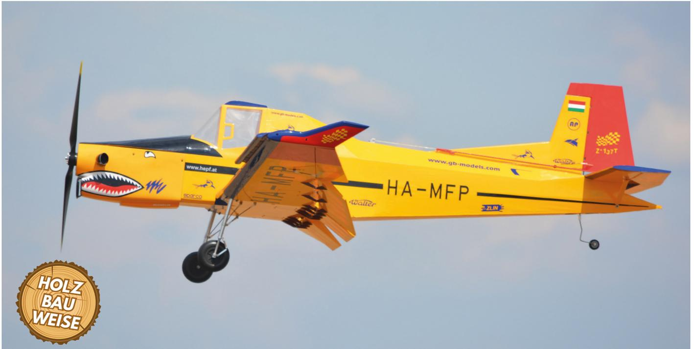
Das Modell der Zlin 137T, einem Agrarflugzeug, mit 2,7m Spannweite wurde in erster Linie für das Schleppen von Segelflugmodellen **bis ca. 20kg** entwickelt. Im Lieferumfang sind neben Rumpf und Tragflächen in Balsa-Sperrholzbauweise auch Kabinen- und Motorhaube, sowie Fahrwerk und Schleppkupplung.
