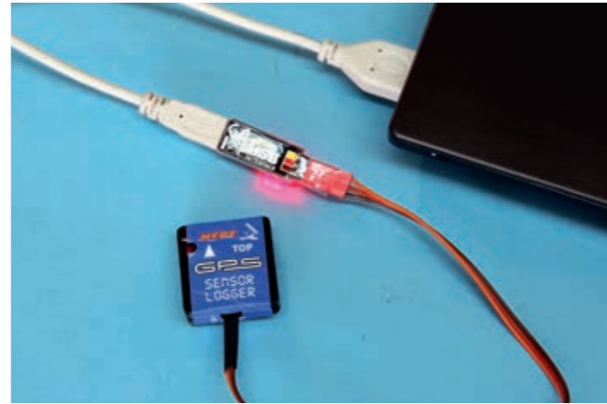
Der GPS-Logger wird direkt an das USB-Interface angeschlossen und braucht keine zusätzliche Stromversorgung
