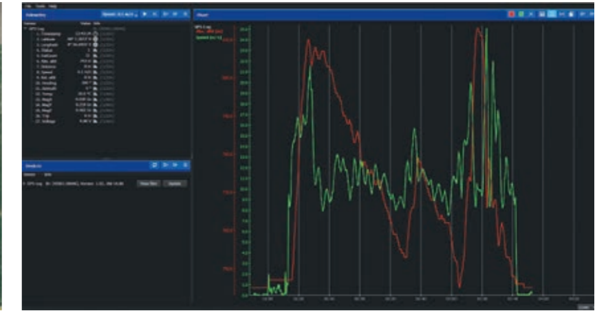
Hier wird die Flughöhe und -geschwindigkeit über die Flugzeit dargestellt
