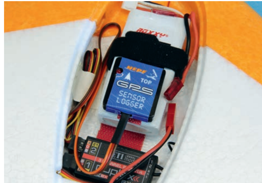
Im FunWing wurde der GPS-Logger einfach auf den Antriebsakku geschnallt
